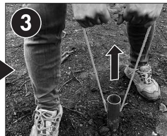
接続穴にロープ等を通して持ち易くし、前後左右に揺すりながら穴を広げて上方向に引き上げる
