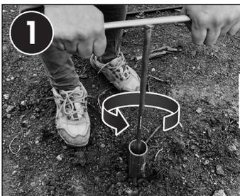
市販のレンチで内部の回転ナットを反時計回り方向に回す
